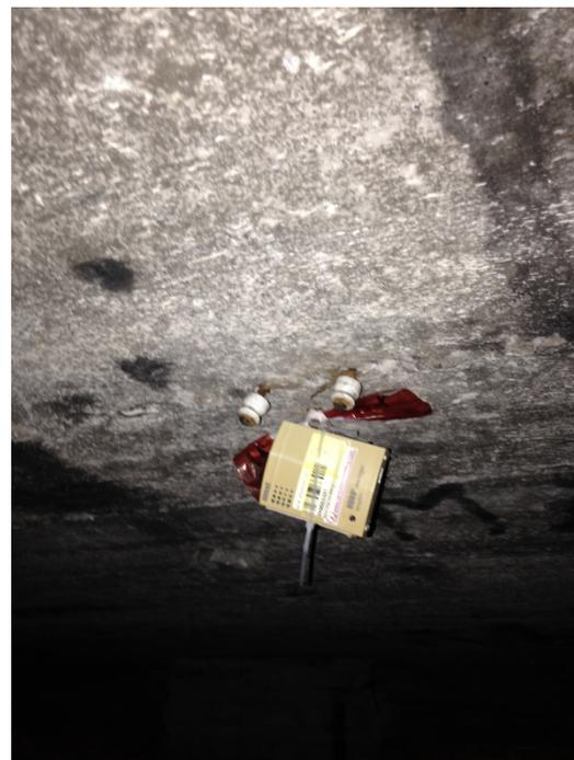
Figura 3. Rilevatore di T/UR
