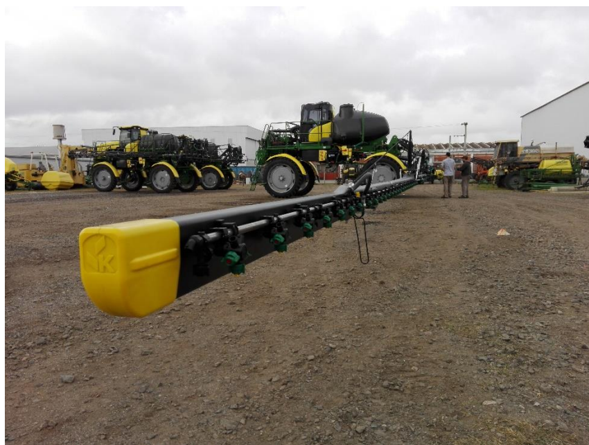
Un braccio del mosquito , macchinario agricolo per le fumigazioni (Las Parejas, 2017)
