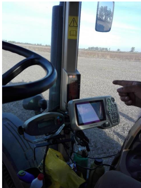
Un trattorista, in occasione di una sessione di semina, mi spiega il funzionamento del pilota automatico con GPS nella sua cabina (Sunchales, 2017)
