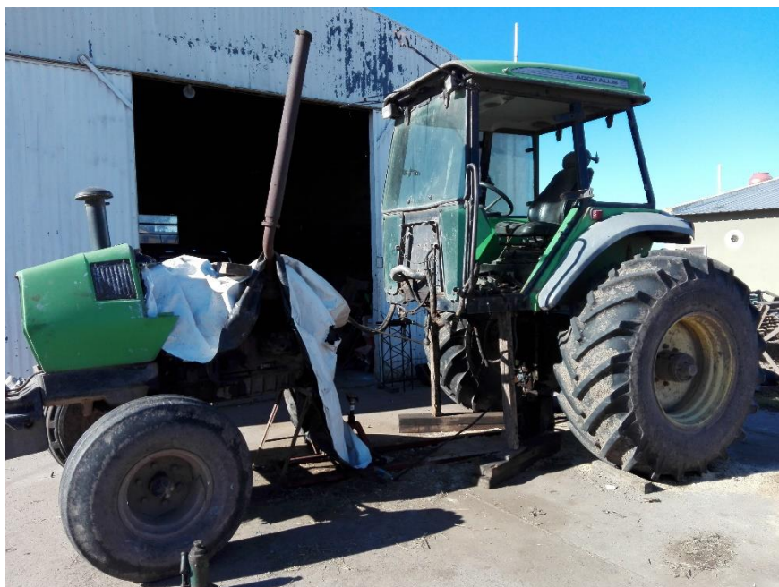
Trattore smontato integralmente per manutenzione e riparazioni (Maria Juana, 2017)
