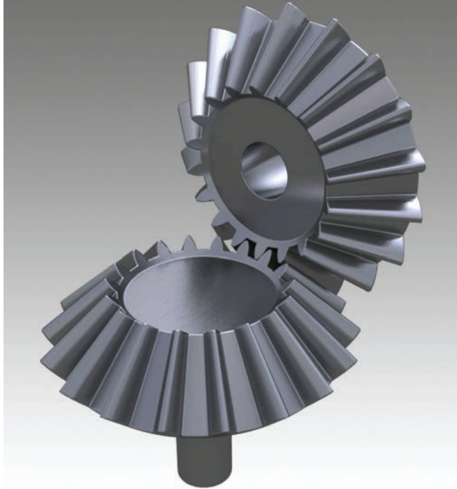
Fig. 14/ Modello digitale di un ingranaggio conico ad assi ortogonali e rapporto di velocità costante uguale a 1 (render Wissam Wahbeh).
