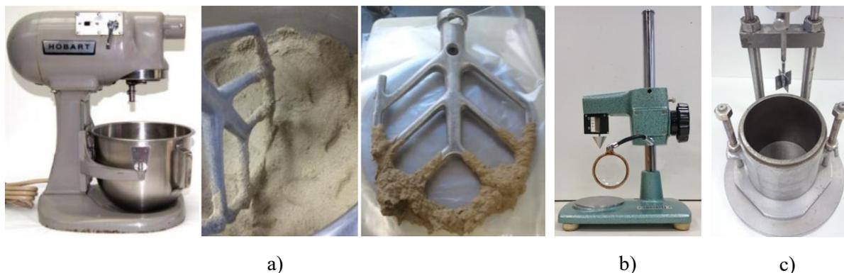
Figura 2 – Apparecchiature utilizzate per la prova di miscelazione (a), fall cone (b) e scissometrica (c).
