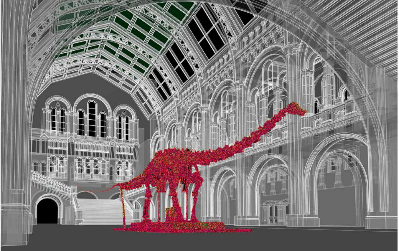
Fig. 3.8 Hintze Hall entrance space within the Natural History Museum, integrazione tra modello parametrico e modelli mesh, elaborazione dei dati di rilievo. Immagine tratta da: S. Antonopoulou, P. B. Frics, 2017. BIM for Heritage Developing a Historic Building Information Model, p.55.
