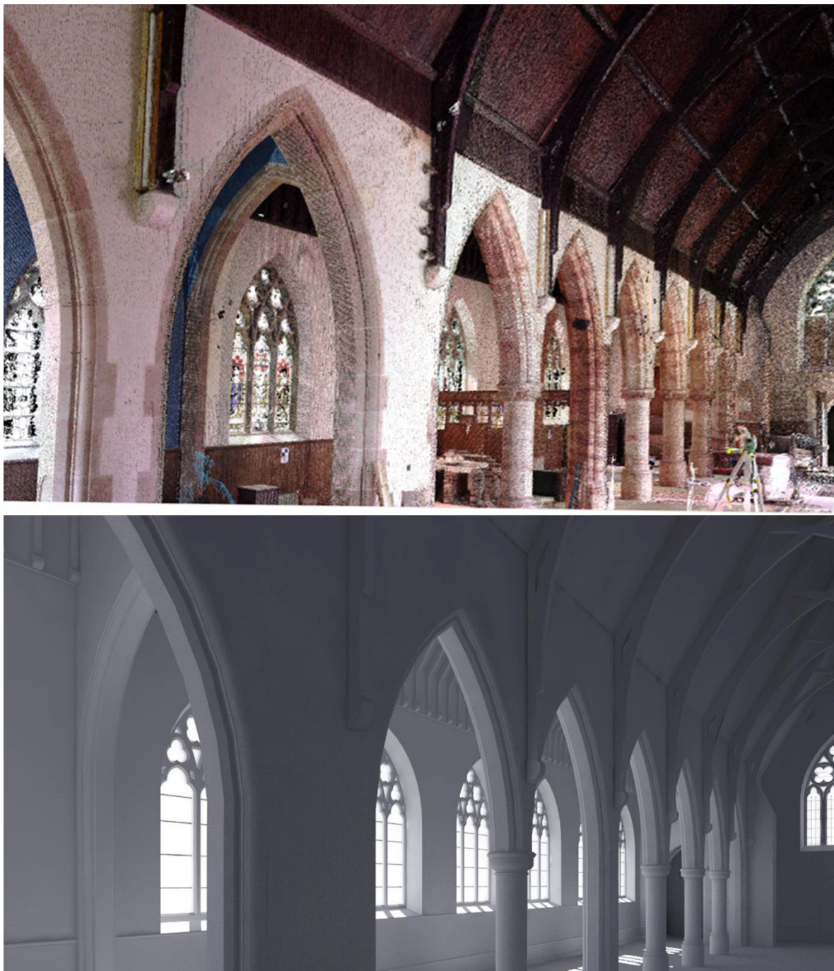
Fig. 2.1 Processo Scan to BIM: dal modello numerico al modello parametrico. Lime architecture, 2017. Modello di una chiesa esistente. ( http://lime-architecture.co.uk/blog/scan-bim-model/ )
