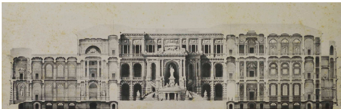
Fig. 10. Palazzo di Giustizia, Sezione trasversale sulla linea spezzata A-B-C-D-E-F; la grande massa del palazzo risulta internamente alleggerita da strutture verticali rarefatte e per l'adozione di colonne e pilastri (F. Piac. B.C.A.S.)
