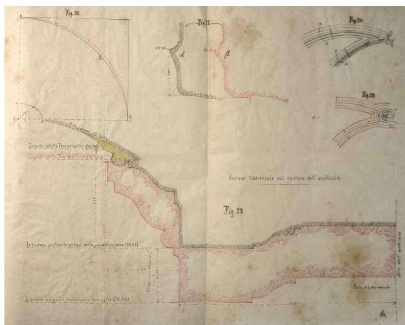
Fig. 5. I disegni di dettaglio descrivono due cambiamenti nel corpo centrale: l'abbassamento delle linee elastiche del telaio sulle tazze e la diminuzione dell'intradosso dell'archivolto. La cornice decorativa delle volte della crociera di Corte dei Conti è stata modificata (ACS, Roma Capitale, Serie M/IV, b. 71)
