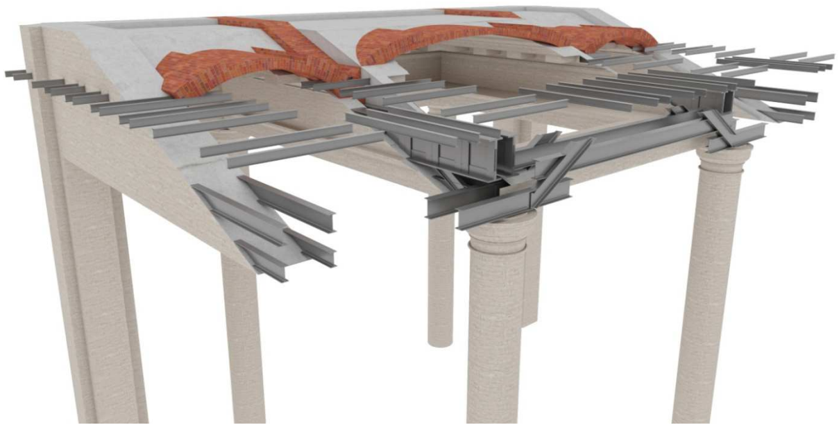
Fig. 22. Ipotesi di ricostruzione grafica tridimensionale del solaio interpiano basata su i disegni di progetto. Vista prospettica (elaborazione dell'autore L. Ninarello)
