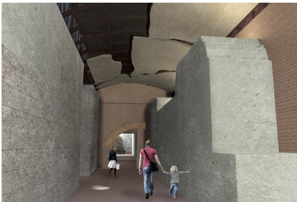
Figura 4.37 Render di progetto: soluzione progettuale con nuova copertura reticolare in acciaio e porzioni corticali originali fissate all'intradosso.
