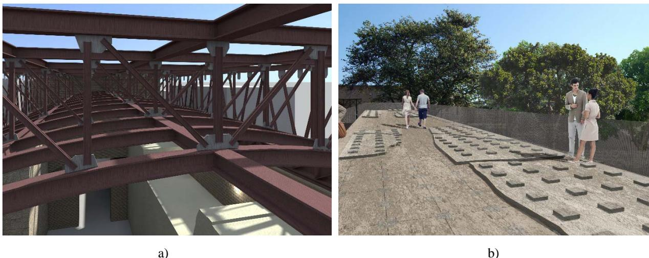
Figura 4.38 Render di progetto: particolare dell'implacato in acciaio (a); terrazza estradossale con porzioni di volta originarie in altorilievo rispetto alla nuova pavimentazione.
