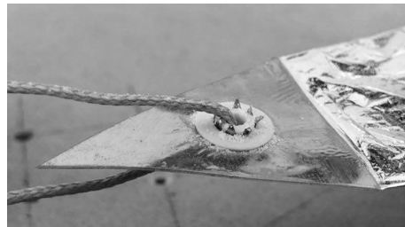
(d) Sample's eyelet detail with tension
