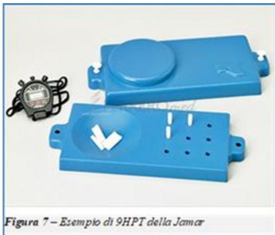
Test (Figura 7). Il test consiste nel prendere dei pioli (5 mm di diametro e 38 mm di lunghezza) uno per volta ed inserirli in nove fori, per poi riposizionarli nel contenitore dove si trovavano inizialmente, il tutto il più velocemente possibile (Davis J. et al., 1999). Il tempo di esecuzione del 9HPT inizia quando il paziente tocca
