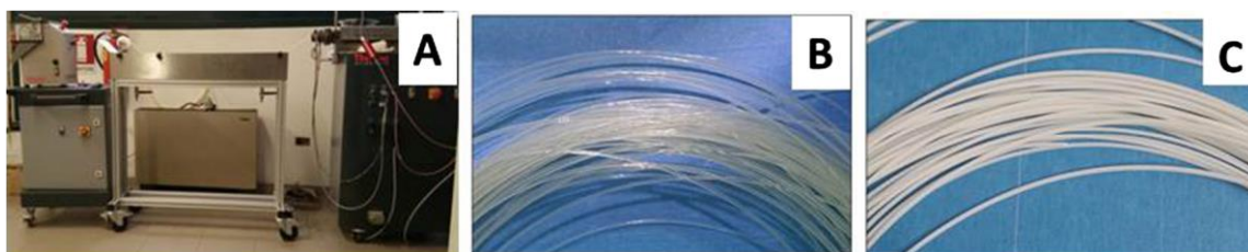
Fig. 53 I filamenti in PLA (B) e in materiale composito basato su PLA e polvere di pietra leccese (C) prodotti attraverso un estrusore (A) per essere utilizzati in processi di stampa per deposizione [Esposito Corcione et al., 2018, p. 281]
