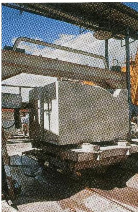
Fig. 29 Macchina di taglio dei blocchi: il telaio monolama [Acocella, 2004, p. 605]
