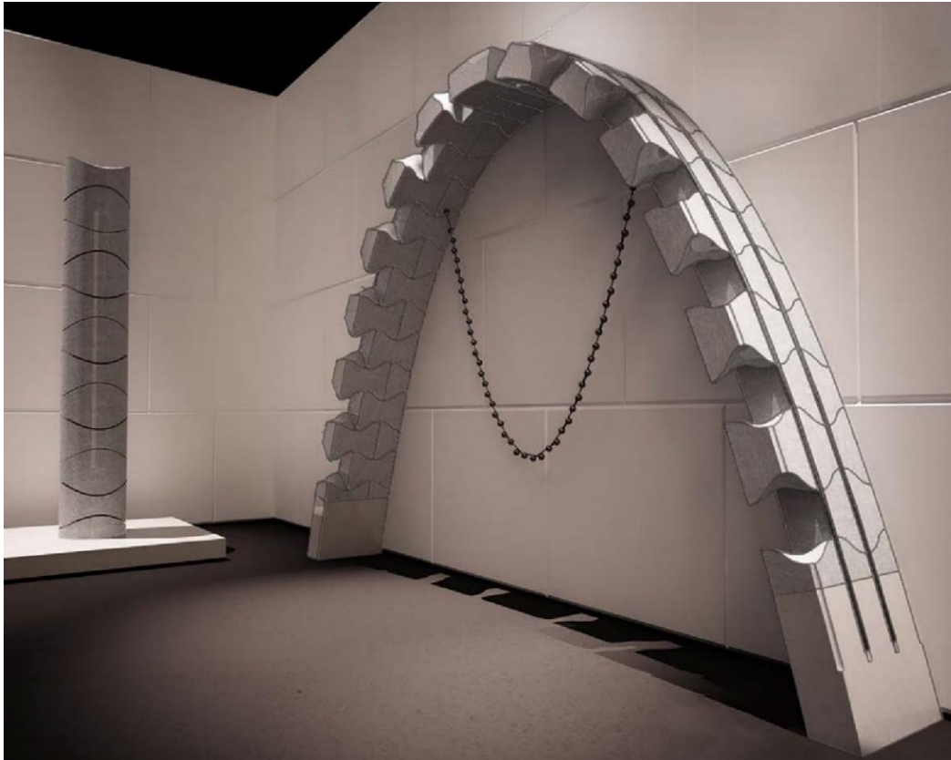
Fig. 47 Arco catenario e colonna a conci osteomorfi [Fallacara, Ferrero, Minenna, 2015, p. 115]
