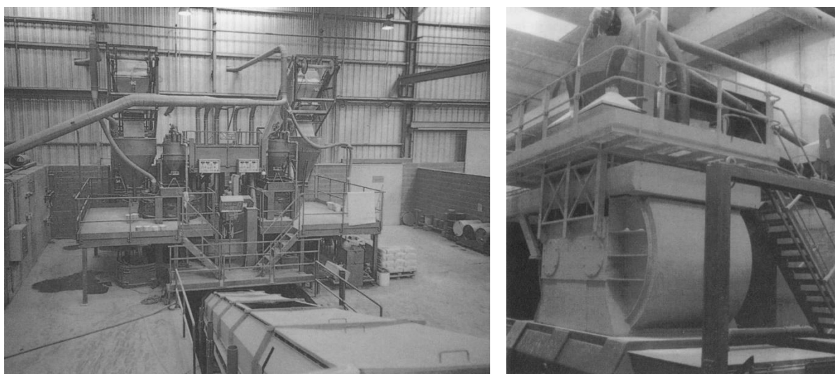
Fig. 34 Vista di un impianto di mescolazione; mescolatrice ad assi orizzontali sottovuoto [Tassone, 2000, pp. 118, 109]
