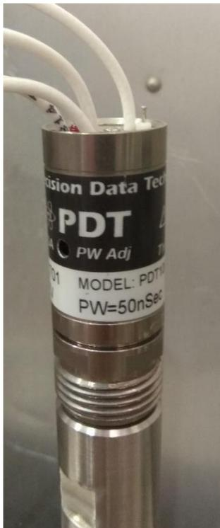
Figura 6-9 – Moduli compatti di monitoraggio neutronico PDT10A.
