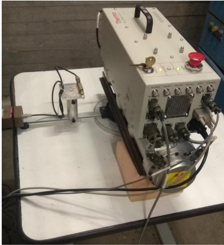
Figura 5-17 – Layout sperimentale utilizzato per la caratterizzazione del generatore mediante rivelatore al diamante.
