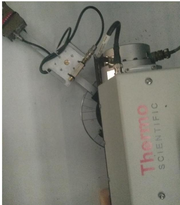
Figura 5-18 – Braccio metallico rotante attorno al target del generatore.
