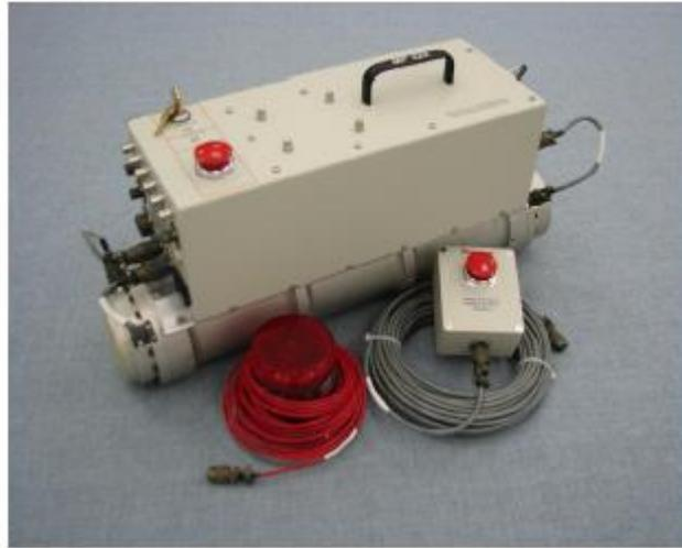
Figura 5-5 – Generatore di neutroni MP320.
