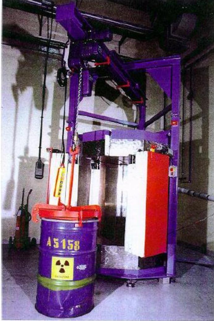
Figura 2-8 – SMNP (Strumentazione per Misure Neutroniche Passive).
