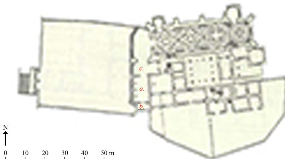
Fig. 1.28. Planta arquitectónica del complejo de Atlixco que indica: a. capilla abierta; b. espacio utilizado probablemente como sacristía; y c. portería del convento. Las indicaciones en rojo, la escala gráfica y el norte han sido agregados por los autores. Fuente: G. Kubler, Arquitectura mexicana del siglo XVI , 1948.
