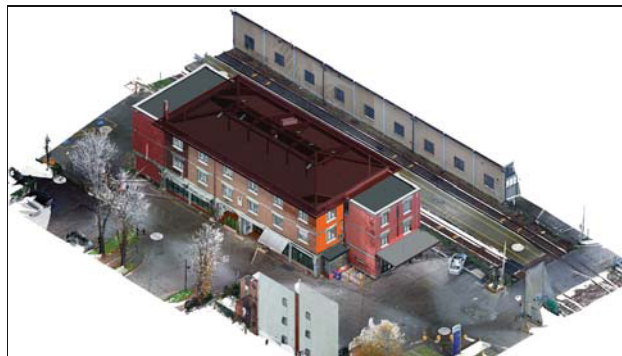
Fig. 2. V. Vespignani, Stazione di Reggio Emilia Santo Stefano, fronti sud-est; vista assonometrica del modello BIM e dell'unione delle nuvole di punti ossia l'insieme degli edifici che, dall'ingresso monumentale.
