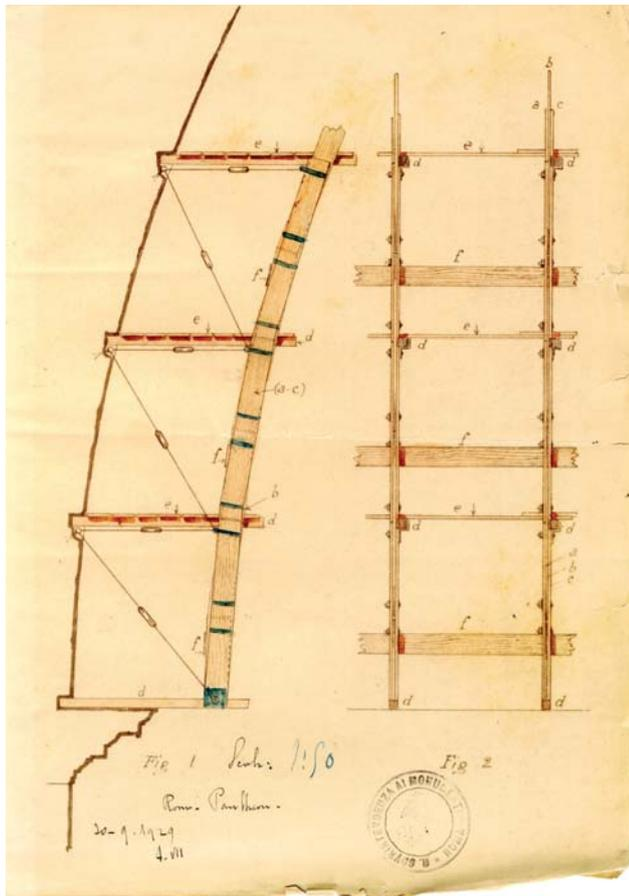
Fig. 1. Disegno del ponteggio ligneo progettato per raggiungere l'intradosso della cupola del Pantheon nel cantiere di restauro condotto fra il 1929 e il 1934 (Archivio Centrale dello Stato, Ministero Pubblica Istruzione, Direzione Generale della Antichità e Belle Arti, Divisione II, 1940-1945, b. 143, fasc. 2513).
