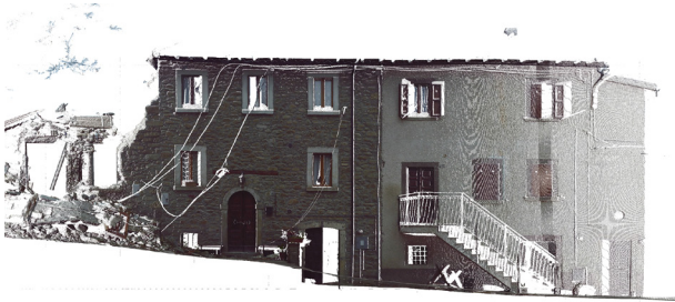
Fig. 5. Ortofoto del modello 3D tratto dalla nuvola di punti (elaborazione di Leonardo Paris).
