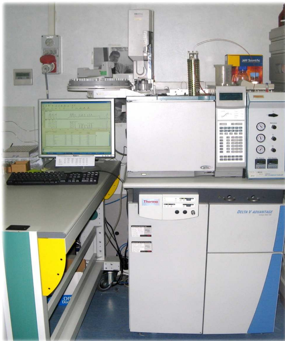
Fig. AI.2. GC-C-IRMS presso il Laboratorio anti-doping di Roma
