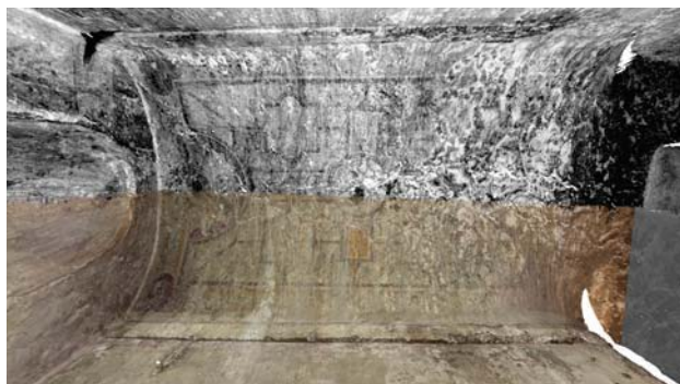
Fig. 2. Il modello numerico è stato mappato con la riflettanza per evidenziare i segni delle decorazioni e con le immagini ad alta risoluzione per evidenziare i colori.
