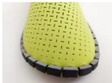
Il processo di montaggio da lastre piane a una forma tridimensionale, senza collanti.
