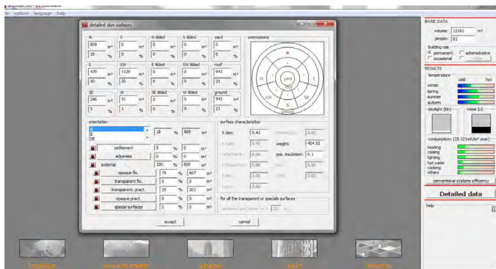
140. Schermata tipo del software Archisun utilizzato per le simulazioni sui consumi energetici.
