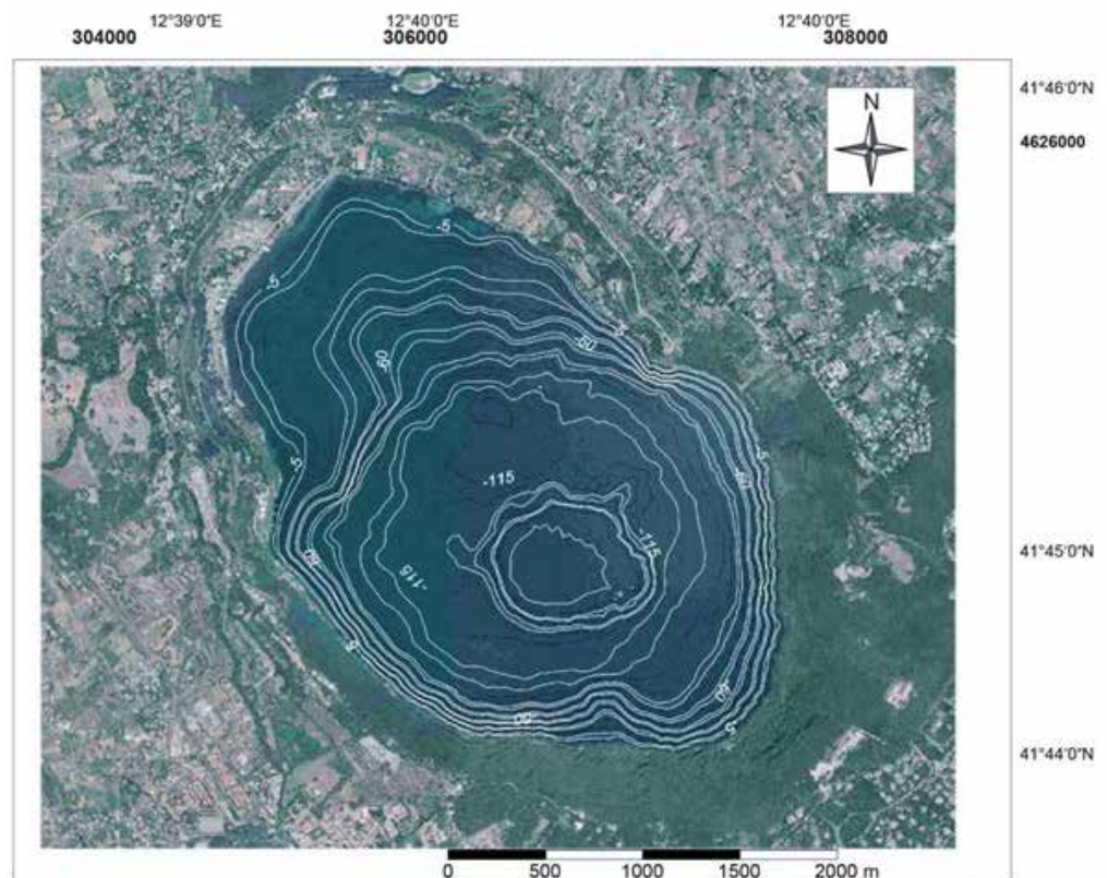
Figura 3. Rilievo orto-batimetrico lago Albano. (Immagine da Anzidei M. et al. , 2006).
