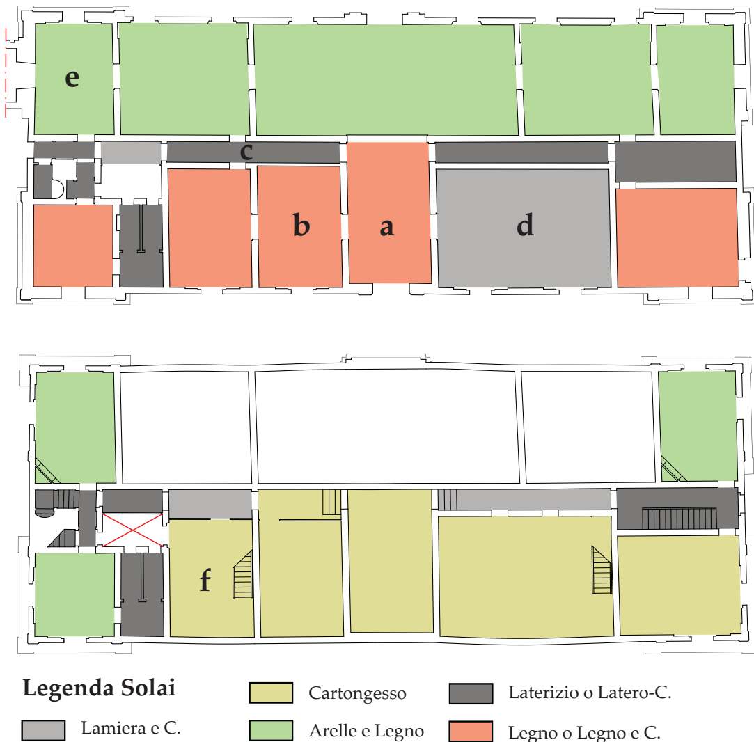
Fig. 6.28. Schema distributivo delle tipologie di solai al primo piano (sopra) e secondo piano (sotto).
