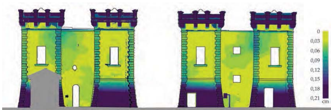
Fig. 6.33. Le due mappature di colore sull'entità dei fenomeni distortivi si riferiscono alla facciata esterna del lato Nord (sinistra) e Sud (destra).
