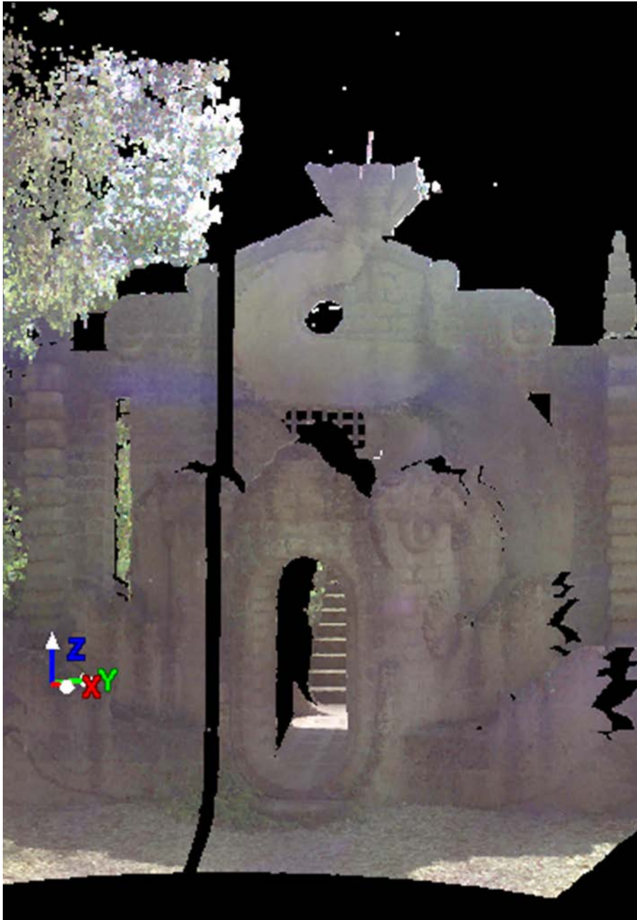
Fig. 1. La Scarzuola, modello numerico (RGB colore) della Bocca della Balena di Giona.
