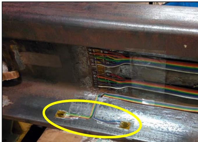
Figura 3.31 – Estensimetri elettrici a resistenza di forma a V
