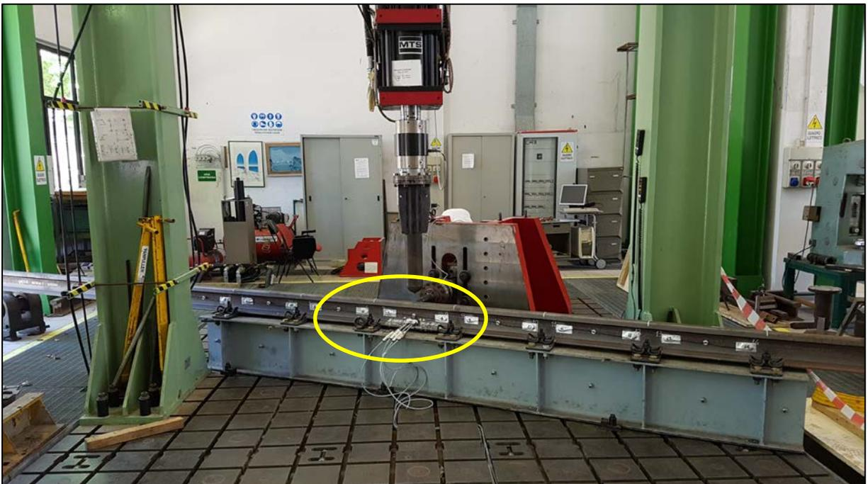
Figura 5.12 – Rotaia di prova al di sotto del portale per l'applicazione delle sollecitazioni [36]
