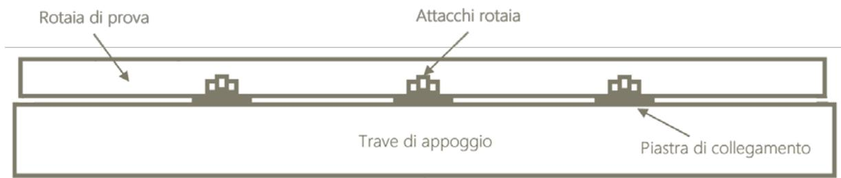
Figura 5.1 - Schema di collegamento rotaia di prova e trave di appoggio (vista laterale) [36]
