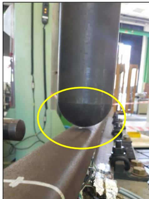
Figura 5.19 – Applicazione della sollecitazione verticale (Q) ad una distanza  $d = 10$  mm dall'asse z in laboratorio [36]
