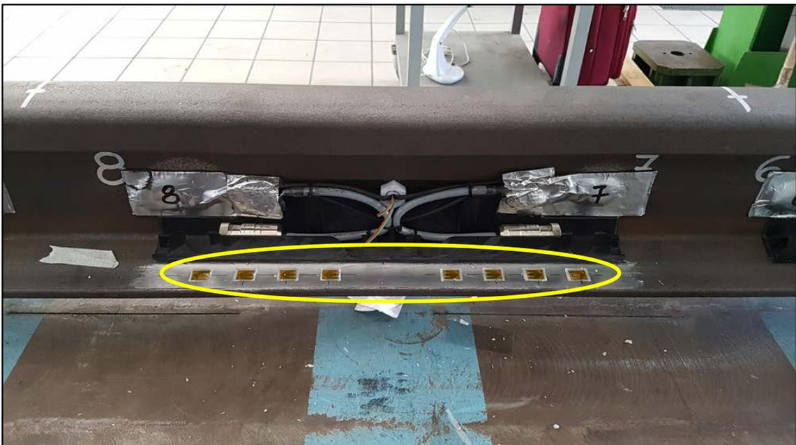
Figura 5.10 – Fine dell'incollaggio degli estensimetri (lato interno della rotaia di prova) [36]
