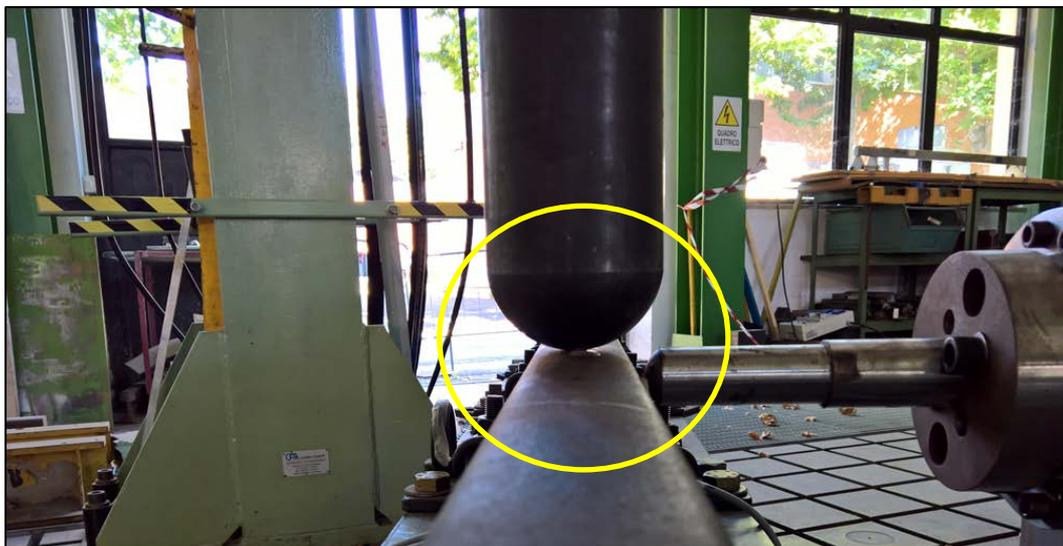
Figura 5.23 – Applicazione delle sollecitazioni verticale (Q) e trasversale (Y) in laboratorio [36]
