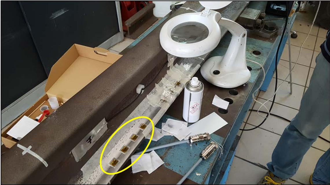
Figura 5.9 – Preparazione delle superfici, tracciatura e prima fase dell'incollaggio degli estensimetri SMCT [36]
