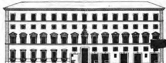
FASE 4: 1675 - Ipotesi ricostruttiva che mostra la sostituzione delle botteghe al pianterreno e del primo mezzanino con finestre inferriate e il coronamento a giorno.
