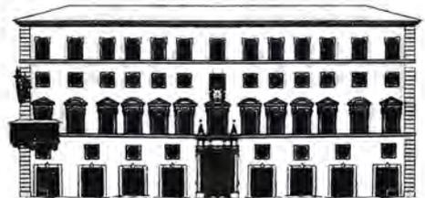
FASE 4: 1675 - Stampa del Falda che mostra la sostituzione delle botteghe al pianterreno e del primo mezzanino con finestre inferriate e il coronamento a giorno.
