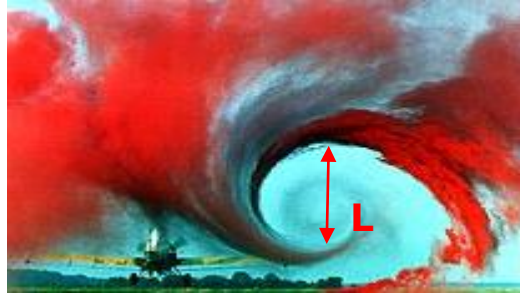
Figura 4.1 Esempio di moto turbolento prodotto dal un aereo e macroscala dei vortici.
