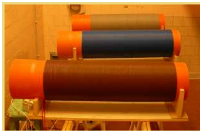
Fig. 7: Solenoidi, progettati e realizzati dal personale dell'ISPESL nella stanza dove avveniva l'esposizione degli animali. Fig. 7: The solenoids in the exposure room. The solenoids used in the experiment were planned by the ISPESL engineers
