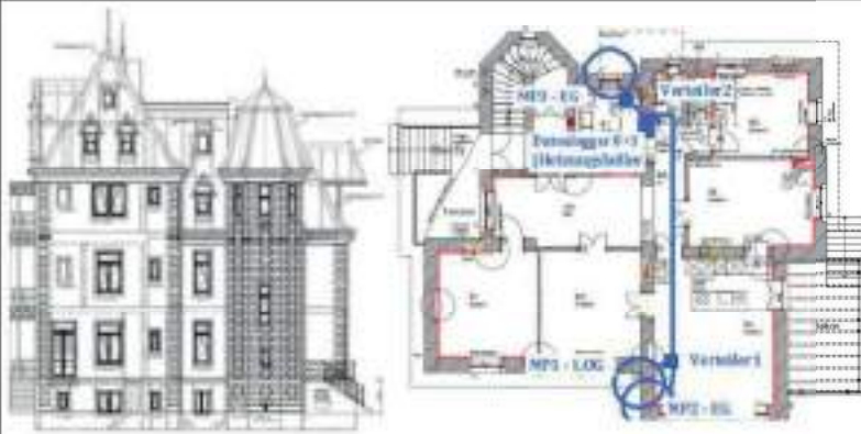
Prospetto principale dell'edificio e pianta con individuati i punti in cui è stato posizionato il sistema di monitoraggio e lo strato isolante
