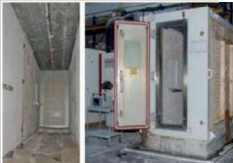
A sinistra la stanza in cui la malta è stata provata prima dell'intervento sul caso studio e a destra la camera climatica in cui sono state fatte ulteriori prove.
