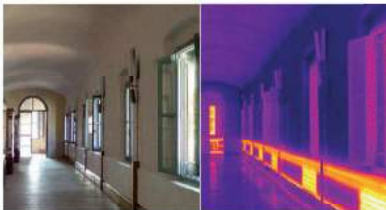
Termografia con individuazione sistema temperierung
