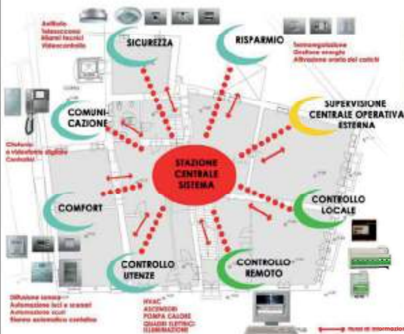
Sistema di controllo degli impianti e dei sistemi di monitoraggio installati
