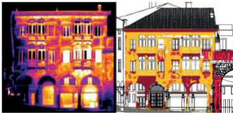
Analisi termografica e rilievo materico e delle criticità
