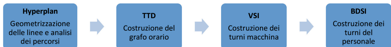
Fig. 4 - Schematizzazione dell'analisi trasportistica. Fig. 4 - Methodology for transportation analysis.
