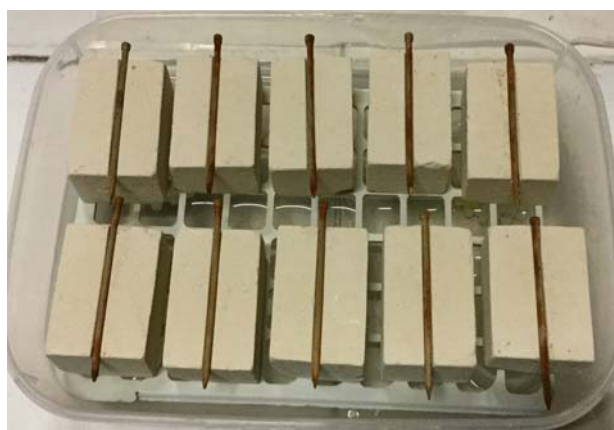
Figura 3.2 Allestimento e posizionamento dei campioni di Pietra di Lecce nel contenitore
