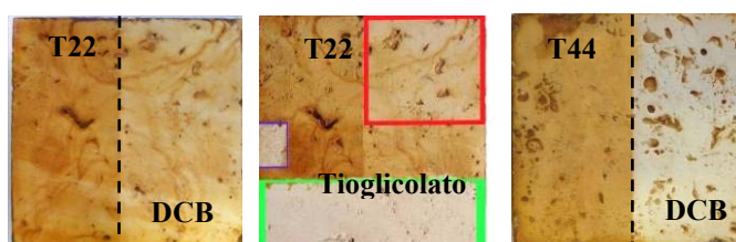
Figura 5.13 Test di pulitura sui provini macchiati con \text{FeSO}_4 \cdot 7\text{H}_2\text{O}
