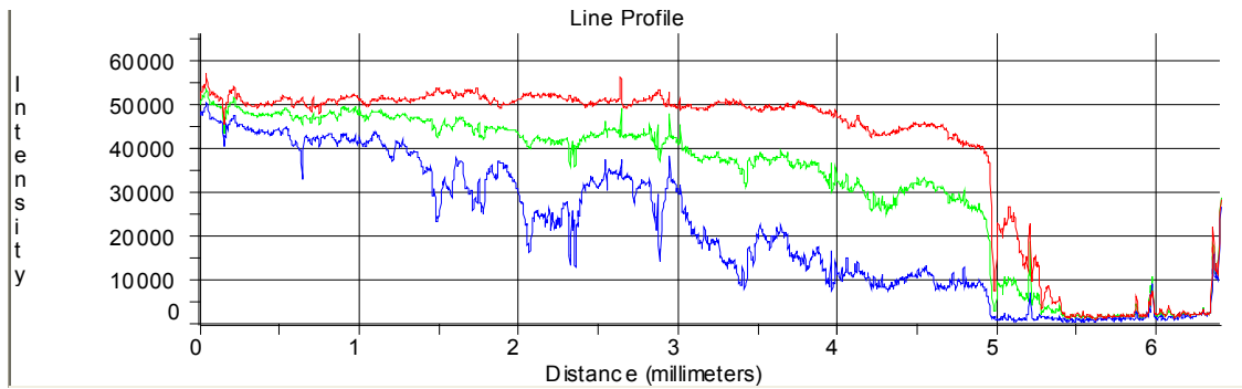
Figura 4.13 Line Profile RGB del campione NS1, che visualizza un grafico bidimensionale delle intensità dei pixel lungo la linea rossa in figura 4.12.
