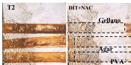
Figura 5.26 Provino T2 prima e dopo i test di pulitura con Gellano, Agar e PVA addizionati con Ditionito-N-acetil cisteina
