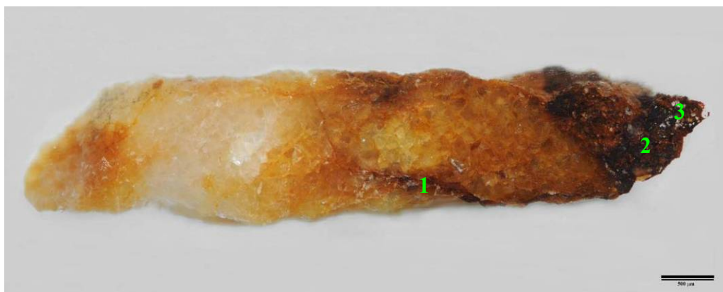
Figura 4.17 Microfotografia della sezione lucida del campione NS3, ingrandimenti 25X. I punti 1, 2 e 3 si riferiscono alle aree osservate a maggiori ingrandimenti e al SEM.
