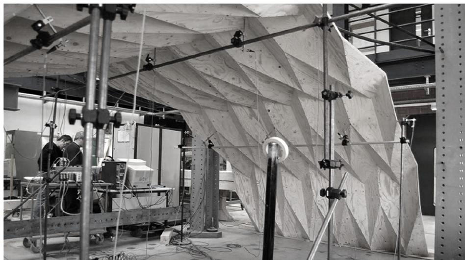
Figura 3.5: Prove di carico su struttura origami
