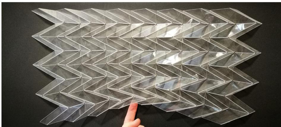
**Figura 7.2: Deformazione in presenza di un carico concentrato laterale**
