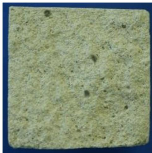
Figura 5.10. a) Micrografia SEM di un campione di fibre milled aggregate in una malta a base di NHL 5; b) Macrofotografia della superficie di un campione di malta a base di NHL 5 addizionate con fibre milled al 6 wt. %.
