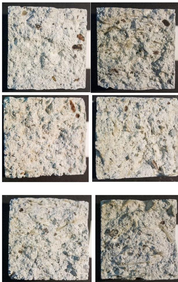
Figura 4.28. Superfici fratturate dei vari tipi di campioni rinforzati con fibre di diverso diametro e lunghezza (iniziando da sinistra in alto REF; B 1%; A3. 1%; A4. 1%; A5. 1%; A6. 1%).
