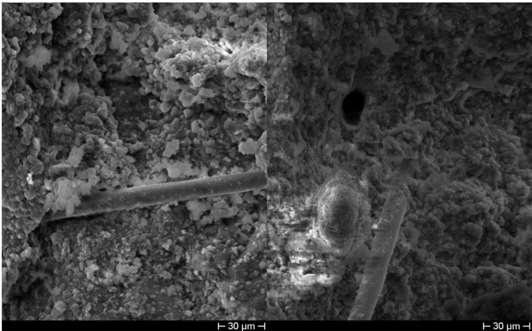
*Figura 5.16. – Micrografie SEM di campione A4 rinforzato all'1% in peso.*
