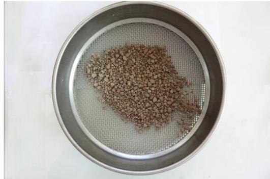
*Figura 2.11. a) colonna di setacci sull'agitatore; b) Aggregato trattenuto nel setaccio.*
