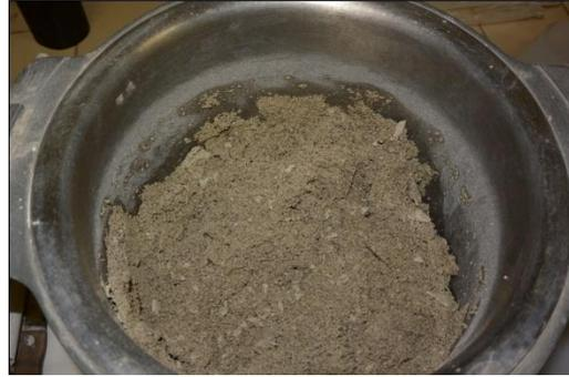
*Figura 3.7. a) Miscelatore automatico della Controls; b) la miscela dopo 30 secondi con aggiunta di sabbia.*
