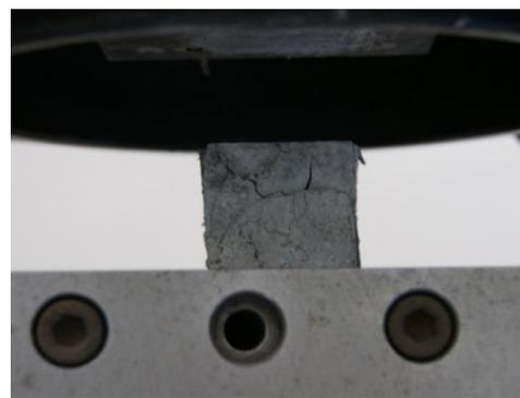
Figura 4.13. Comportamento tipico di compressione di a) campioni rinforzati con fibre milled; b) campioni rinforzati con fibre chopped.
