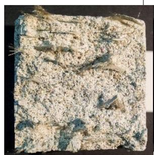
*Figura 4.26. Superfici fratturate dei vari tipi di campioni rinforzati con fibre di diverso diametro o lunghezza. (Iniziando da sinistra in alto. REF; A4 1%; A4. 2%; A5. 1%; A5. 2%; A6. 1%; A6. 2%).*
