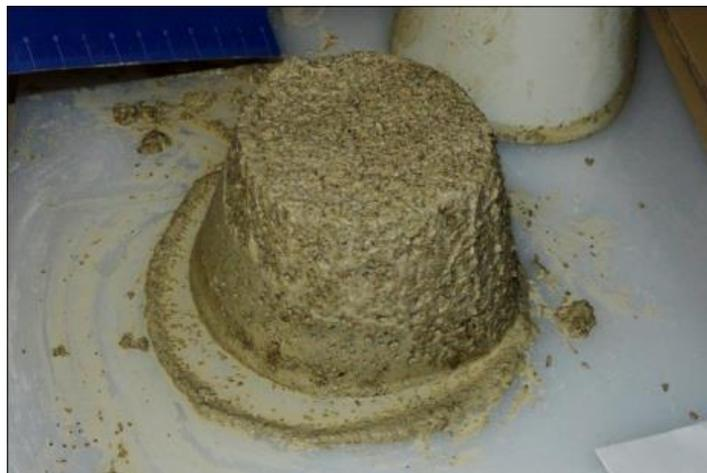
*Figura 3.2. Slump della miscela di legante con sabbia 1:2 e rapporto acqua /legante 0.6.*
