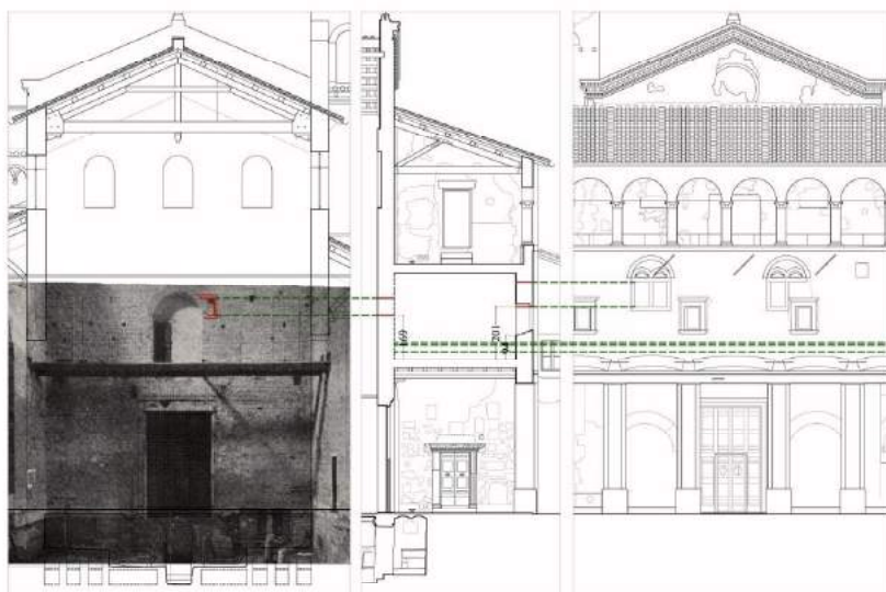
Fig. 33 – Le finestre primitive della galleria in rapporto alle quote di calpestio attuali
