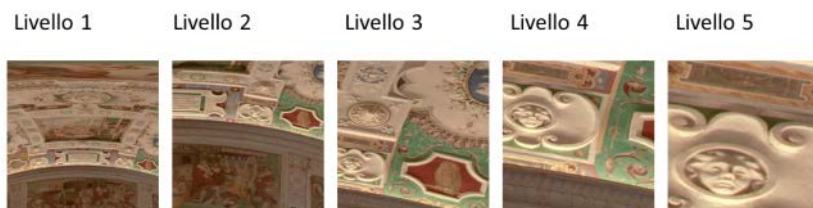
Fig. 2. Tasselli dell'immagine piramidale che ritraggono il medesimo soggetto a risoluzioni differenti. Ogni tassello ha una dimensione di 256 x 256 pixel.
