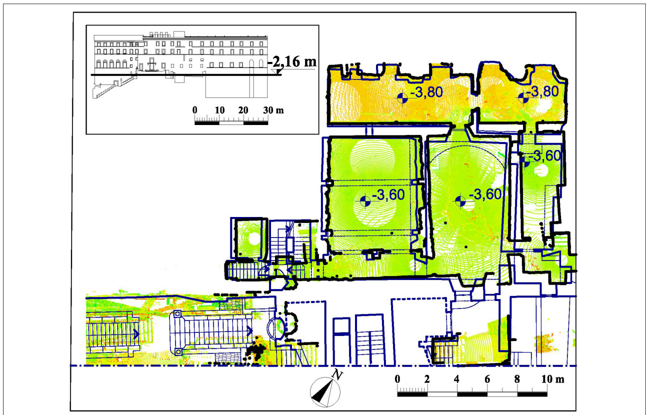
Fig. 2. Roma. Complesso scolastico Angelo Mai, pianta a quota -2,16 m con la sovrapposizione del rilievo del 2012 (in blu) e dei dati desunti dalla nuvola di punti del 2013 (a colori half space ; in nero view slice con piano di sezione 2 cm) (scansione ENEA con laser scanner HDS3000 Leica Geosistem).
