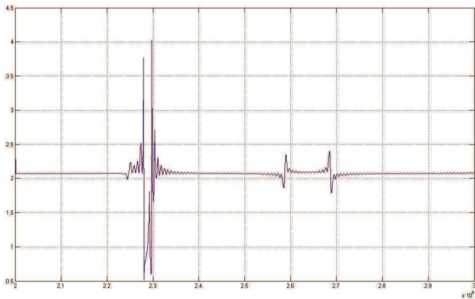
Figura 6-5 Permittività elettrica gap d'aria  $h = 1.0$  mm lungo l'asse  $y$
