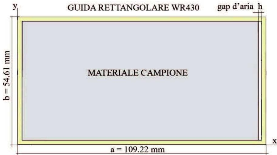
Figura 6-8 Ssezione trasversale guida wr430 con gap d'aria di spessore h lungo il lato corto
