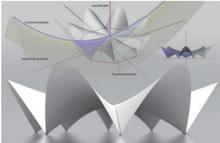
Figura 3. Analisi geometrica dei paraboloidi iperbolici che definiscono il Manantiales Restaurant di Felix Candela (1958).
