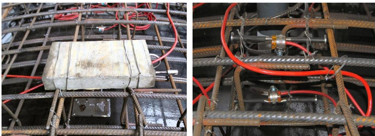
Figura 5.25. Particolare della cella di pressione e delle barrette estensimetriche.
