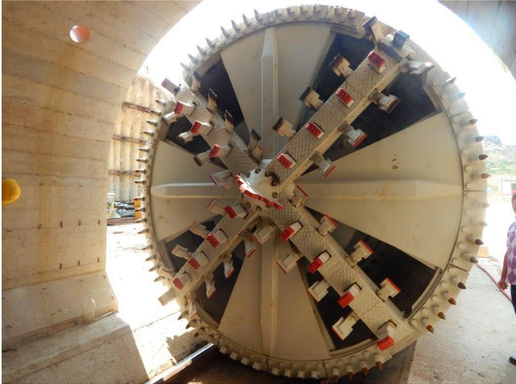
Figura 5.6: Testa fresante della TBM.
