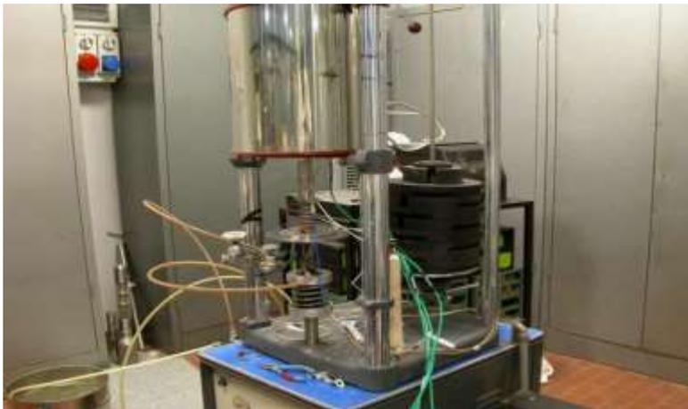
Figura 61: predisposizione del forno per prova di creep.
