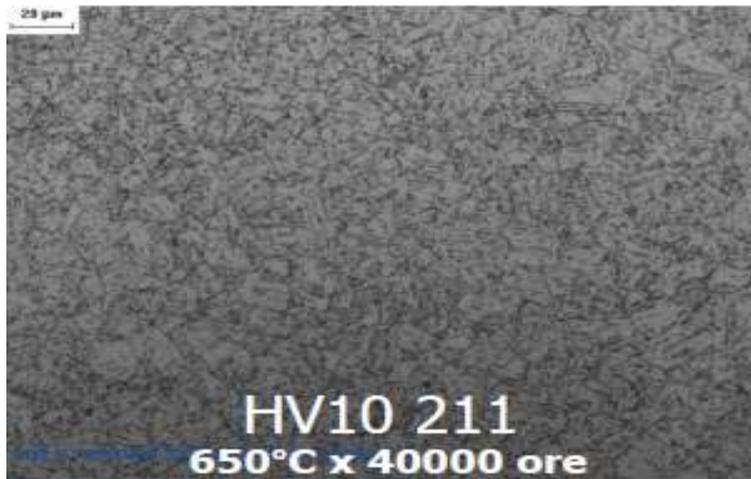
Figura 20: esame post invecchiamento di campione P91 al microscopio ottico.
