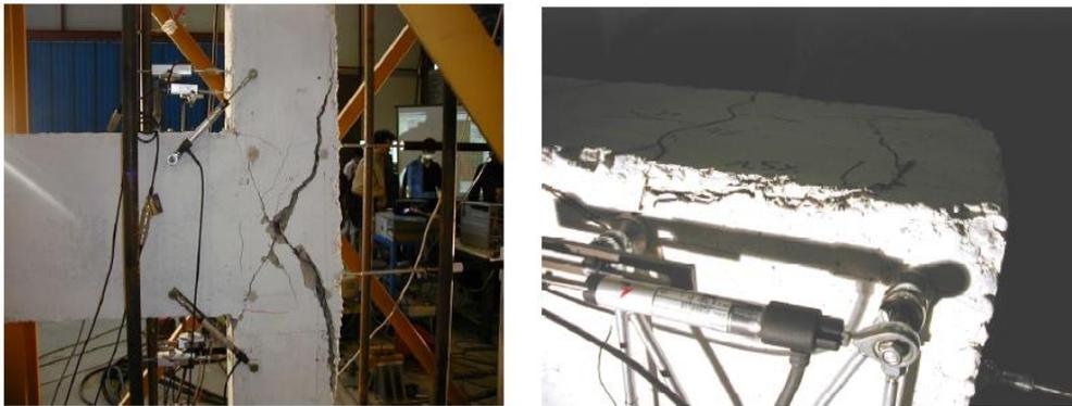
**Figura 10: Meccanismi inelastici dei nodi esterni**
