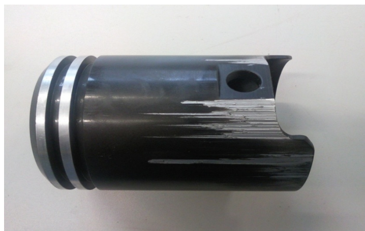
Figura 5:25: Il pistone usurato per effetto delle spinte radiali.
