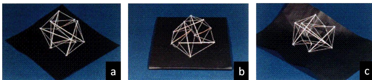
Fig. 2.4) Modello tensegrale cellulare realizzato mediante bastoncini in legno ed elastici. Il modello assume forma arrotondata quando non ancorato (a), allungata se fissato ad un substrato rigido (b), corruga un substrato non rigido nel ritirarsi (c).
