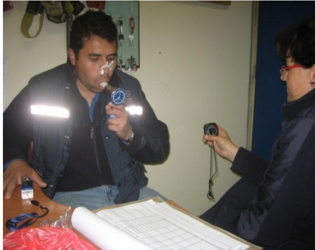
Figura 4.5: Foto di un lavoratore di Codelco Andina durante ESS. Osservare gli apparecchi da destra a sinistra: cronometro, scheda di registro dei dati, Fingertip Oximeter e Wright Respirometer.
