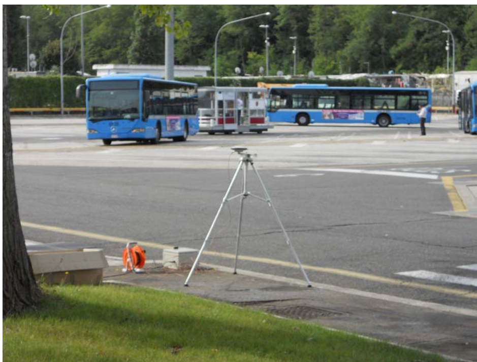
Figura 25 - Il veicolo durante i test presso il deposito della Magliana. In primo piano l'antenna base del GPS differenziale che permette il funzionamento del veicolo e la sua localizzazione.
