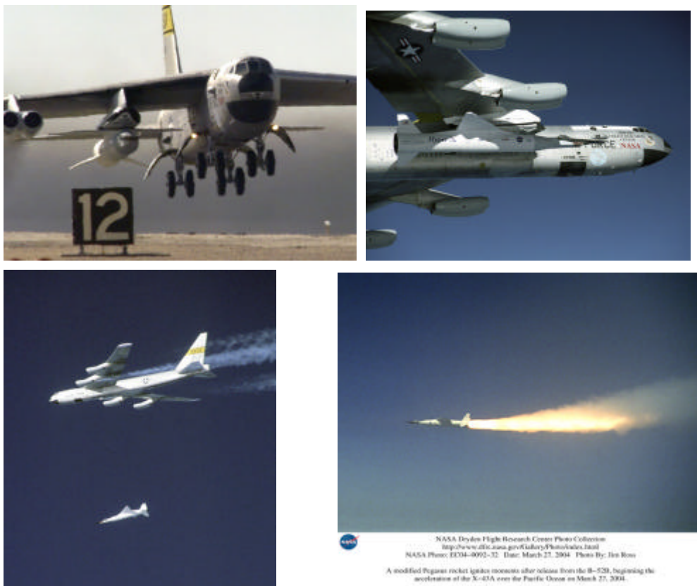
Figura L10 Fasi di decollo, distacco e volo dell'X43
