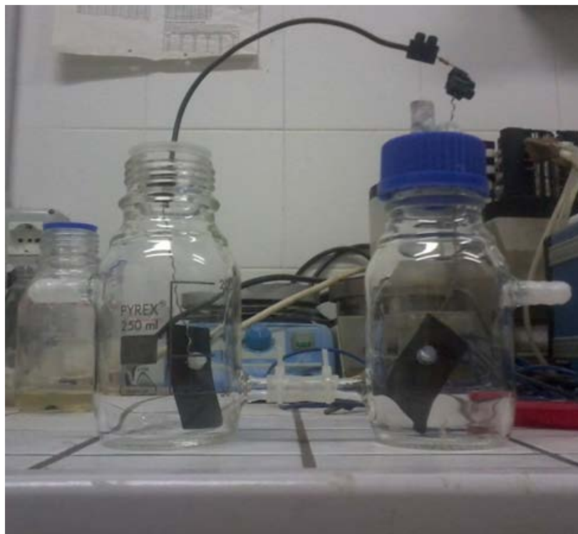
Figura 6.1: MFC H-Type con membrana di 0,5 cm 2 ed elettrodi con grafite siliconata.
