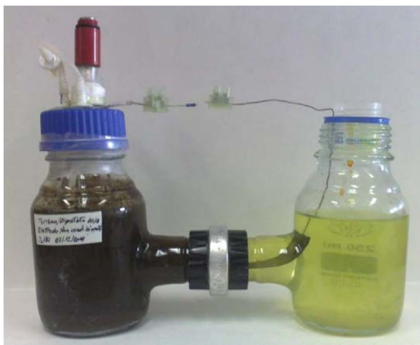
Figura 6.5: MFC H-Type utilizzata per la sperimentazione
