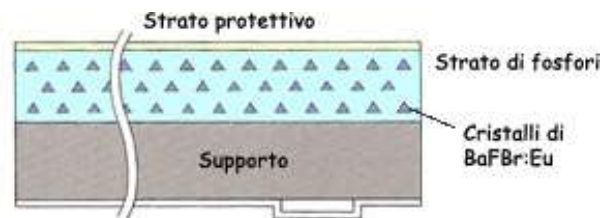
Fig. 3.3 Schema della struttura di una lastra IP.
