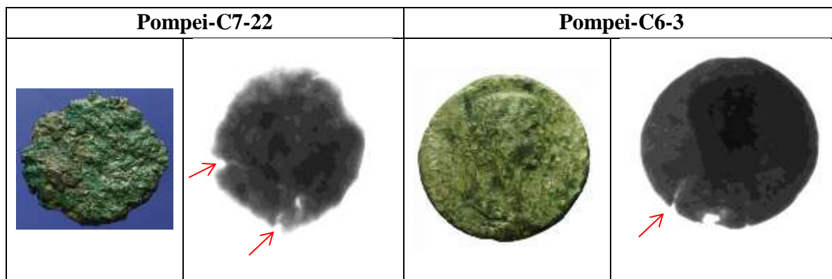
Fig. 7.11 Radiografie di monete provenienti da Pompei, le frecce rosse indicano le cricche nel metallo non visibili ad occhio nudo.
