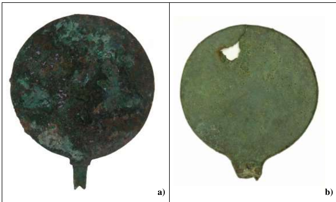
Fig. 8.1 a) Specchio A è ben visibile la patina di prodotti di corrosione non uniforme; b) Specchio B sono ben visibili le parti metalliche mancanti (manico e parte del piano) e lo strato di corrosione uniforme.
