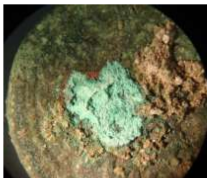
Fig. 7.16 Moneta 5 da Villa Medici, è evidente l'attacco del cancro del bronzo.
