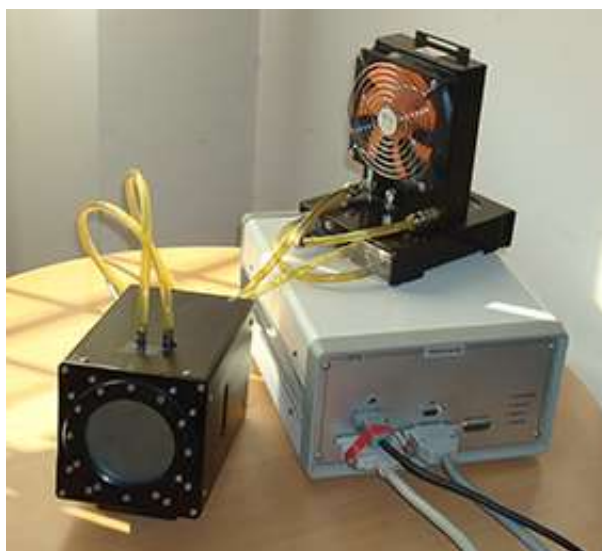
Fig. 4.8 Foto camera DTA ad accoppiamento diretto. Da sinistra camera, sistema di raffreddamento e camera controller.
