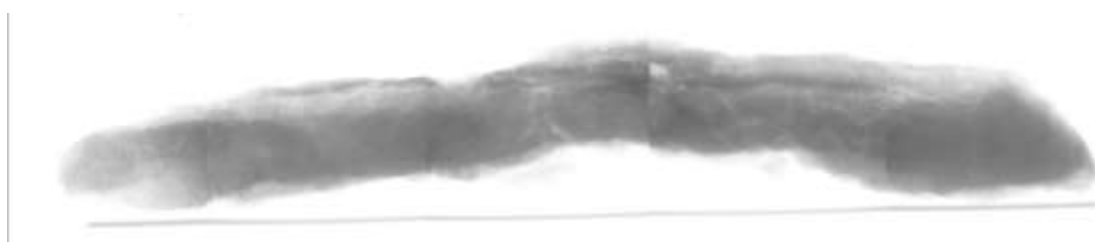
d) Immagine radiografica laterale dopo ricostruzione e rielaborazione digitale; 90 kV, 1.5 mA, 10 s ciascuna esposizione
