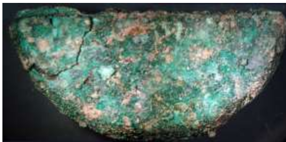
Fig. 7.12 Foto al microscopio ottico della moneta 1 ritrovata a Villa Medici. Si nota l'estrema eterogeneità della patina di prodotti di corrosione e terra che la ricopre.
