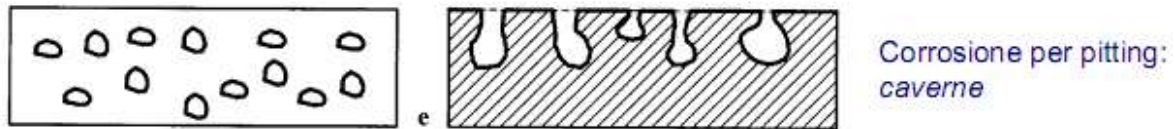
Fig. 8.7 Schema degli effetti della corrosione per pitting a caverne.
