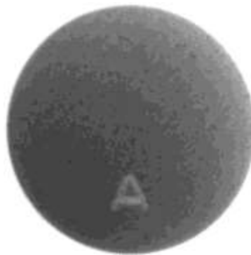
Fig. 7.9 Radiografia di uno standard di bronzo 95 kV-1.5 mA-5 s (Cu 77.43% -Pb 7.9% - Sn 7.16 % - Zn 6.02 % - As 0.19 % - altri elementi 1.3 %) L'immagine è stata ingrandita e contrastata da software per migliorare la visibilità della tessitura della lega.
