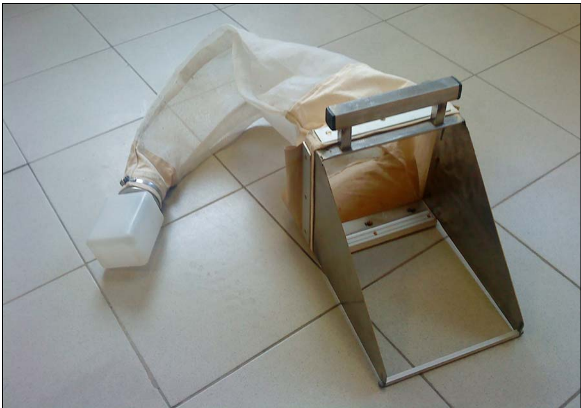
Figura 8. Rete surber con telaio anteriore delimitante 0,05 m 2 Figure 8. Surber net with 0.05 m 2 sampling area
