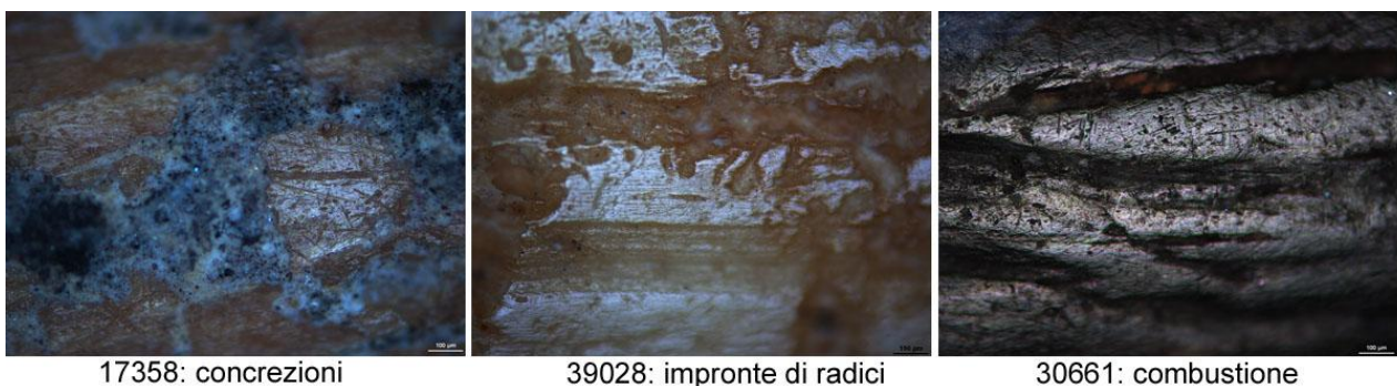
Figura 66 Ingrandimento a 100X di porzioni di superficie di tre prodotti finiti della collezione che rivelano le alterazioni di superficie descritte: 17358 esempio di superficie ricoperta da concrezioni; 39028 esempio di impronte di radici corrispondenti al solco dal profilo irregolare; 30661 superficie relativa ad un prodotto sottoposto a combustione. Per realizzare gli scatti al metallografico e mettere in risalto la variazione cromatica abbiamo adoperato per tutti gli oggetti lo stesso filtro. Scatti G. Petruzzo.
