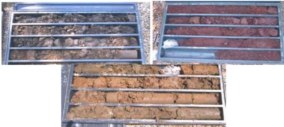
Figura 3.10 - Cassette di terreni prelevati nei cantieri della Metro C, Roma Est (si riconoscono i terreni PN, PR e TF).
