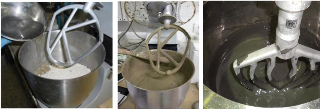
Figura 4.9 - Aggiunta di acqua al terreno ed omogeneizzazione (miscelatori Kenwood e PARI).
