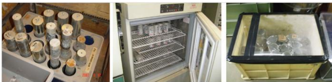
Figura 2.8 - condizioni di maturazione in presenza di sovraccarico (SGI), in camera umida a temperatura costante, all'interno di contenitori sigillati con strato d'acqua al di sotto dei provini.
