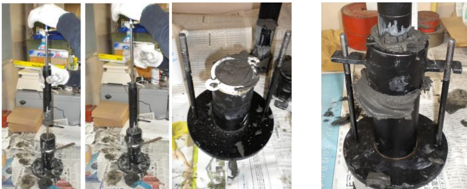
Figura 4.17 - Tecnica Compattazione Dinamica, D.C.; esempio di espulsione di miscela (D.C. - m2).
