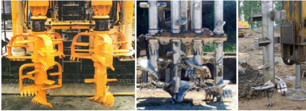
Figura 1.4 - Metodi wet mixing in Giappone, U.S.A. ed Europa (Yoshida, 2002; Burke, 2002; Topolnicky, 2003).
