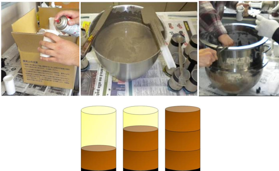
Figura 4.14 - Applicazione grasso spray, inizio confezionamento (presso DICEA e presso PARI) e schema disposizione della miscela nello stampo in tre strati.
