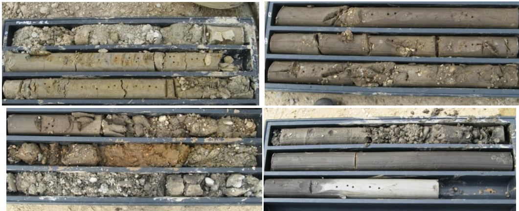
Figura 3.9 - Cassette di terreni campionati nell'area di Malagrotta, Roma Ovest (si riconoscono i terreni RL, SL, SG ed AP).
