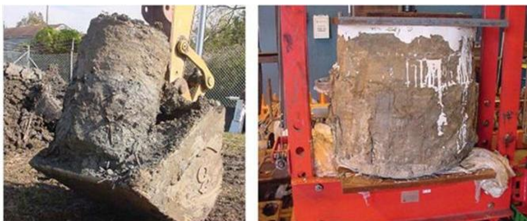
Figura 2.20 - Colonna Deep Mixing estratta ed esecuzione prova di compressione (Bruce 2012).
