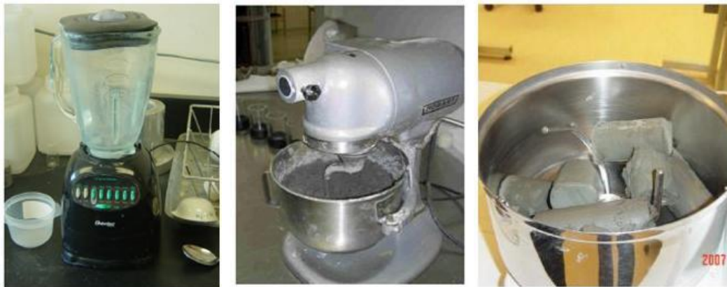
Figura 2.5 - Miscelatore utilizzato per amalgamare acqua e legante, miscelatore (Virginia Tech.) Hobart per miscelare terreno e legante (Helsinki University of Technology), miscelatore per omogeneizzare il campione di terreno (Swedish Geotechnical Institute).
