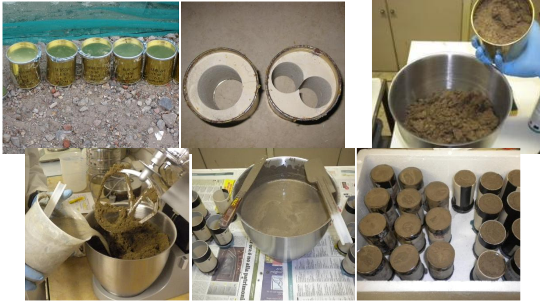
Figura 3.15 - Prelievo di campioni wet grab in sito, successivamente carotati, e fasi di confezionamento dei provini in laboratorio.
