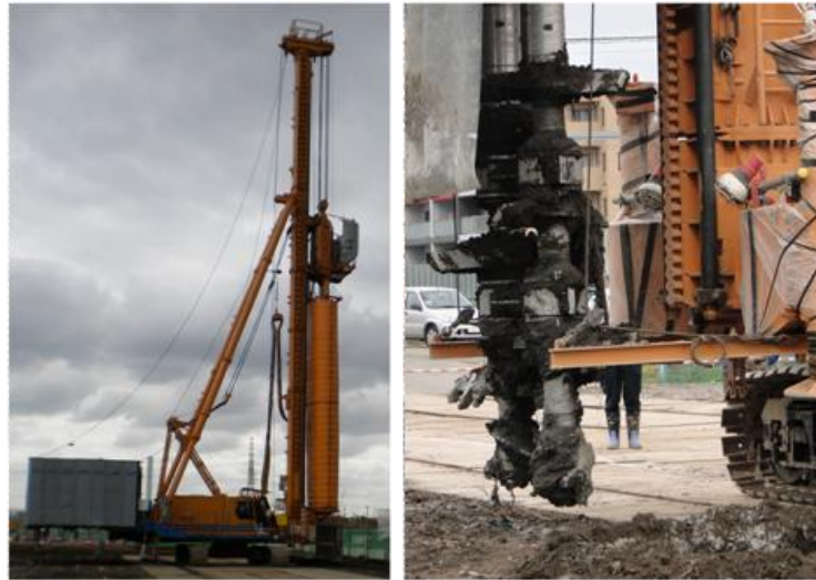
Figura 2.27 - Macchinario CDM impiegato, particolare delle lame miscelatrici rotanti.
