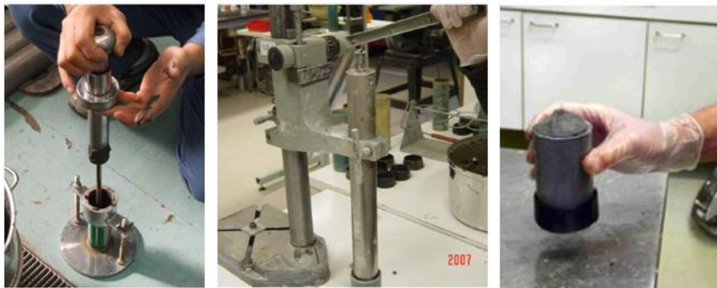
Figura 2.6 - Compattazione dinamica e Compattazione statica (SGI institute), Tapping (Helsinki University of Technology).
