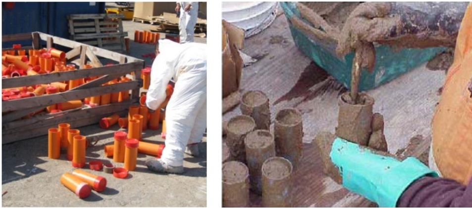
Figura 2.17 - Esempi di stampi e tecnica di confezionamento impiegati in un cantiere.
