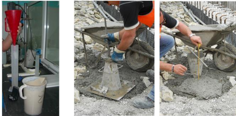
Figura 2.39 - Misurazioni mediante cono di Marsh e cono di Abrams.
