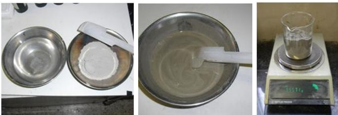
Figura 4.10 - Preparazione malta cementizia (acqua più cemento) o cemento asciutto.
