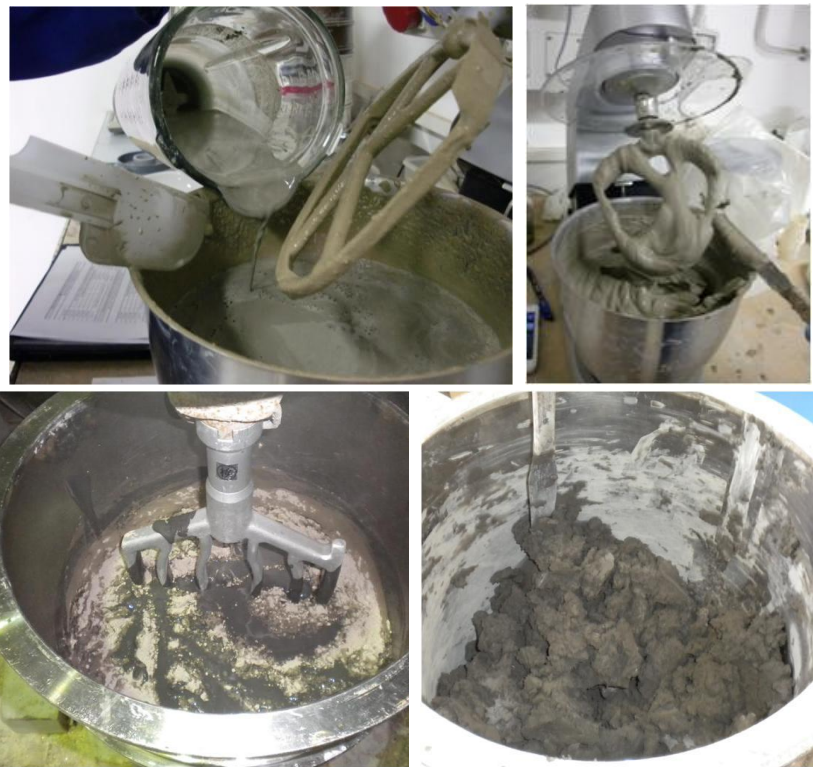
Figura 4.11 - Aggiunta del legante in forma di malta oppure a secco; pausa per distaccare il materiale attaccato alla lama e alle pareti della ciotola (presso DICEA e presso PARI).
