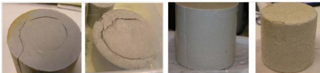
Figura 1.28 - da sinistra verso destra: provini di argilla stabilizzata con PC-cenere volante e esposti a soluzione di solfato di sodio 10% di cenere volante per 68 giorni e 50% di cenere volante per 12 giorni; provini di argilla stabilizzata con PC-zeoliti immersi per 1.5 anni in soluzione di solfato sodico e soluzione di acido solforico (Osman, 2007).
