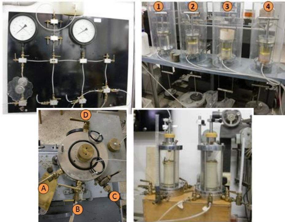
Figura 3.20 - Pannello Belladonna, celle di carico, valvole del plinto di base e prove in parallelo in corso (DICEA).
