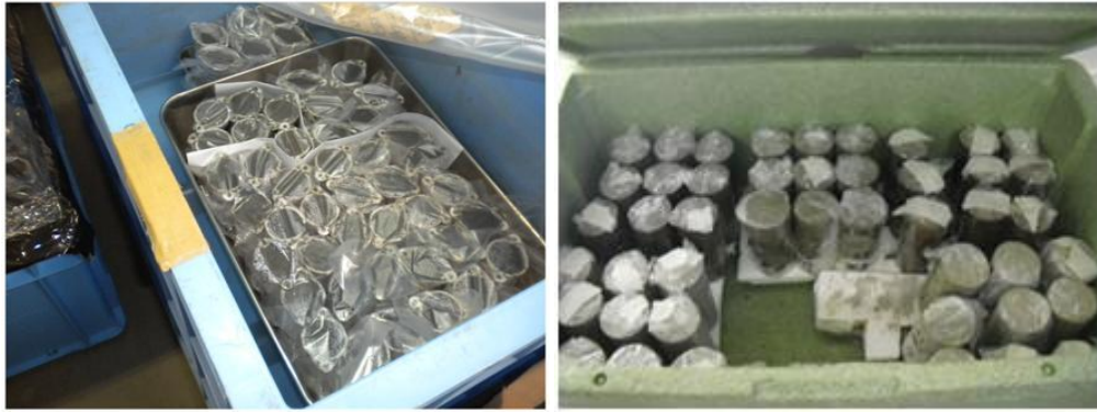
Figura 4.19 - Disposizione dei provini opportunamente sigillati all'interno della cassetta di maturazione.
