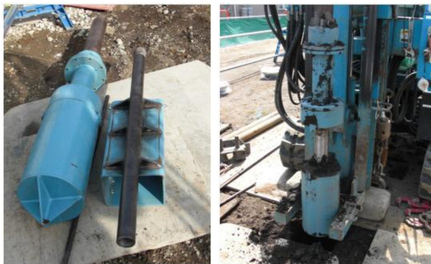
Figura 2.16 - Due tipologie di campionatori a sezione circolare e rettangolare (Kitazume 2012).
