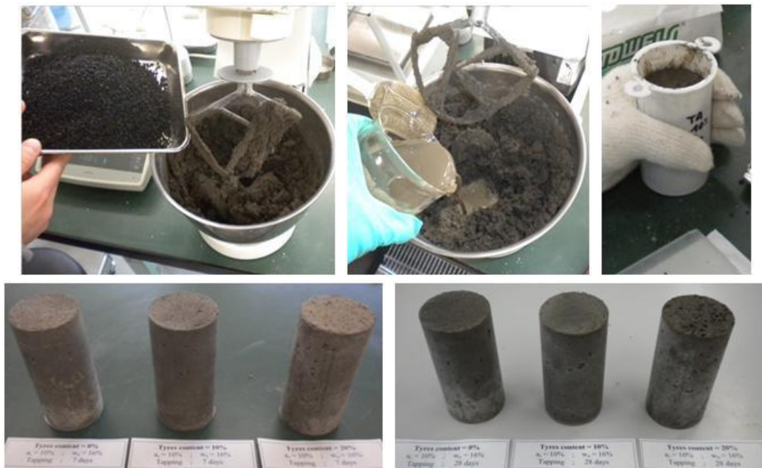
Figura 3.5 - Fasi di confezionamento dei provini di miscela terreno-cemento-tire chips (aggiunta di tire chips, aggiunta malta cementizia e confezionamento mediante Tapping) e serie di provini per le prove di permeabilità in fase di compressione testati a 7 e 28 giorni.
