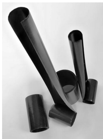
Figura 2.4: la configurazione cilindrica chiusa si può ottenere avvolgendo quella aperta dopo averne appiattito il lato corto.
