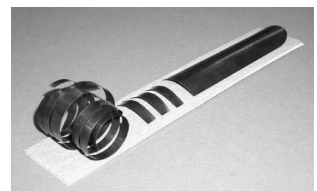
Figura 2.16: in un bracciale a scatto le strisce longitudinali e trasversali hanno curvature opposte; da Kebadze et al. [91].
