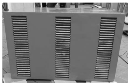
(a) Involucro edilizio adattivo proposto da (D'Annibale et al. [42]), modello in scala.
