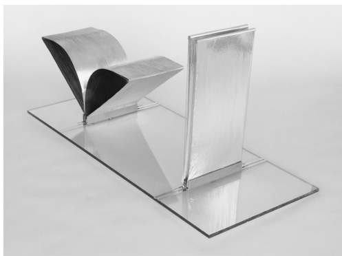
(e) Involucro edilizio adattivo proposto dalla Decker Yeadon LLC, modulo nastriforme in elastomero dielettrico.
